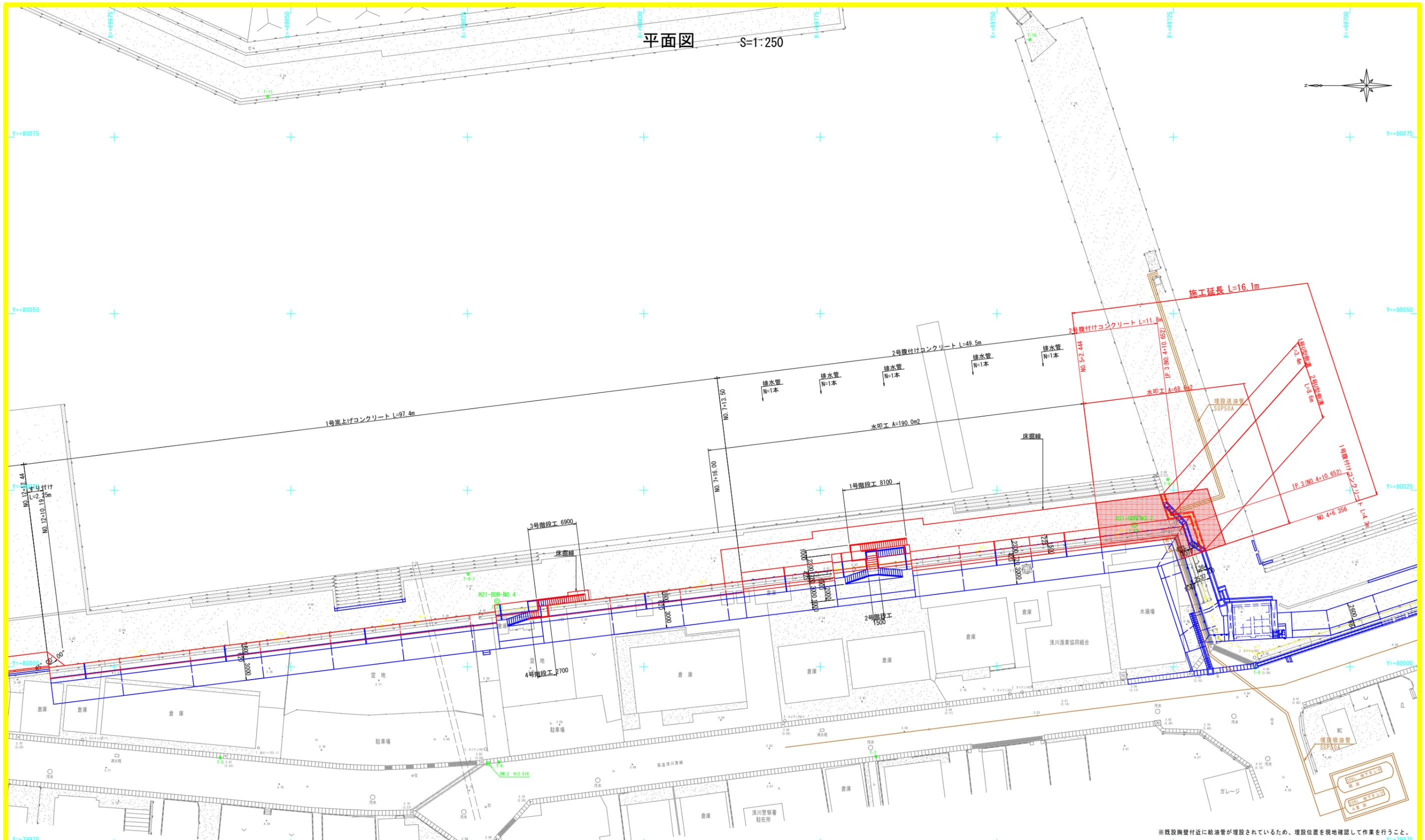
※既設胸壁付近に給油管が埋設されているため、埋設位置を現地確認して作業を行うこと。
